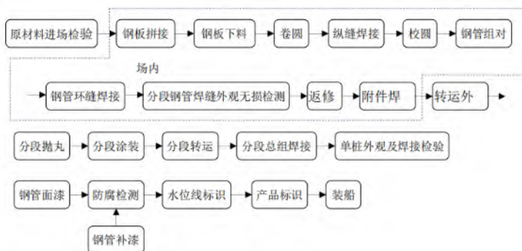
图 3.1.5-2 钢管桩制作工艺流程图
