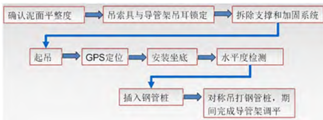
图 3.1.5-5 导管架施工工艺流程图
