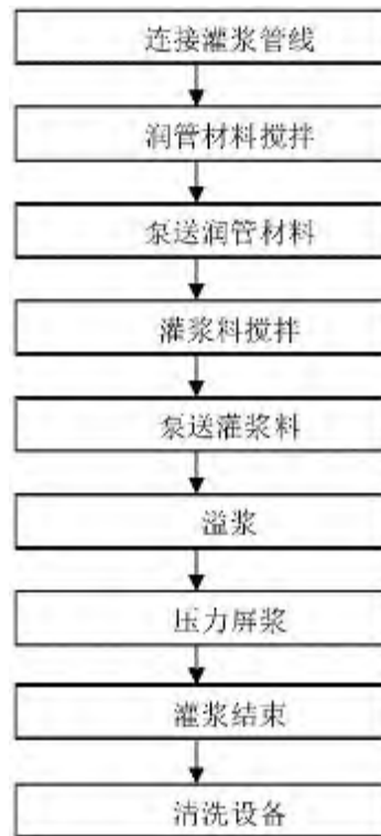
图 3.1.5-6 灌浆施工工艺流程图
