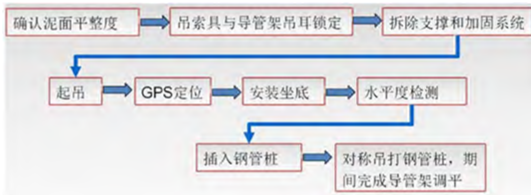
图 3.1.5-5 导管架施工工艺流程图
