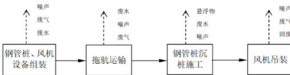
图3.2-1 风机施工主要工序及产污环节
