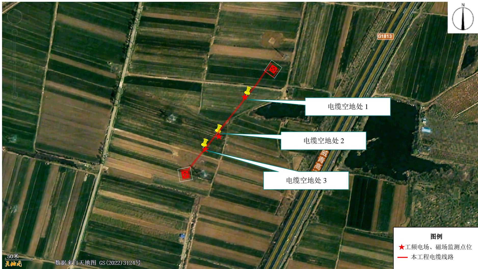
附图5 本工程线路路径及检测布点示意图（220kV神岙I、II线12-#13塔线路下地工程检测示意图）
